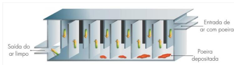
**7) Filtração (S+L; S+G):** processo mecânico de separação de misturas **sólido-líquido** ou **sólido-gás**. A mistura é separada pela utilização de um **filtro**, que retém o sólido (resíduo) e deixa passar o líquido (filtrado) ou o gás.
