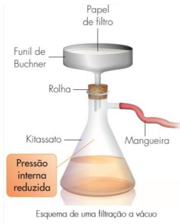
**8) Dissolução fracionada (S+S; L+L):** processo físico de separação de misturas **sólido-sólido**, baseado na diferença de solubilidade dos componentes da mistura em um dado solvente. O princípio do método é adicionar um solvente, que dissolva somente um dos componentes da mistura e, por filtração, separa-se o outro componente. Após a filtração o solvente é evaporado, e o componente solúvel é recuperado.
