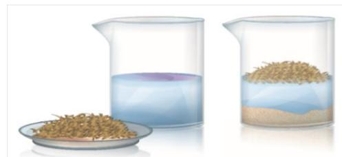
**10) Flotação (S+L):** nesse método de separação, a mistura é submetida a uma forte corrente de ar, que provoca a formação de uma espuma que reúne uma parte da mistura na superfície. Esse processo é muito utilizado na separação de minérios pulverizados da respectiva ganga (impurezas) e no tratamento de esgoto. Normalmente, a flotação é facilitada pela adição de uma substância denominada agente de flotação, que é escolhida previamente, dependendo da mistura cujos componentes devem ser separados.
